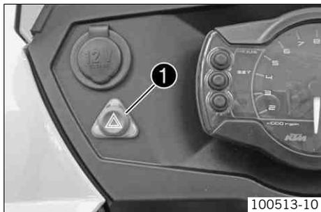
Der Warnblinkschalter ❶ ist links neben dem Kombiinstrument angebracht. Die Warnblinkanlage wird zum Anzeigen von Notsituationen verwendet und um andere Verkehrsteilnehmer zu warnen.
