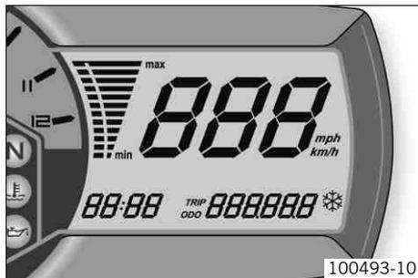
Beim Einschalten der Zündung leuchten eine Sekunde lang alle Anzeigesegmente zum Funktionstest auf.
