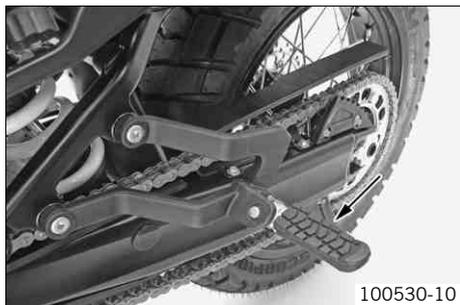
Die Beifahrerfußrasten sind klappbar ausgeführt.
