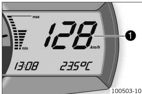
Die Geschwindigkeit ❶ wird in Kilometer pro Stunde **km/h** bzw. in Meilen pro Stunde **mph** angezeigt.
