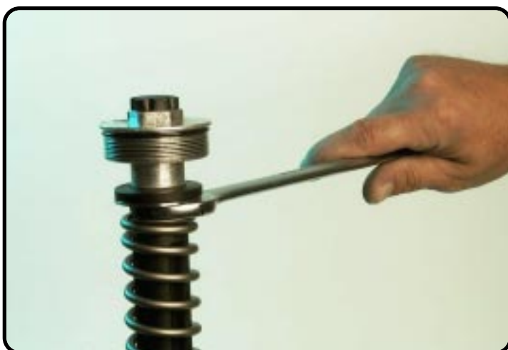
...und Gabelschlüssel 22 am Hydraulik-Stop ansetzen.
