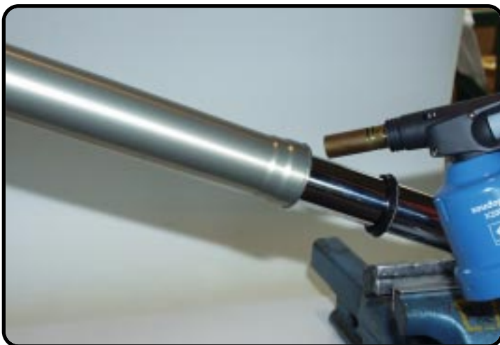
1. Außenrohr auf Höhe Öldichtring erwärmen.
