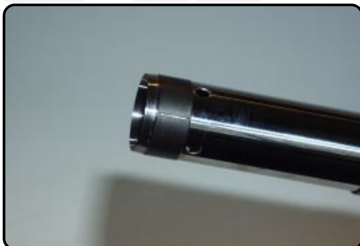
Führungsbüchse Innenrohr montieren.
