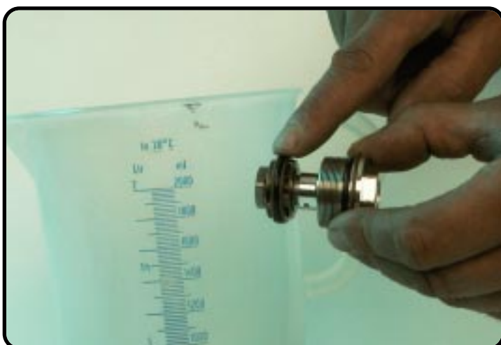
O-Ring Druckstufenkolben mit Gabelöl ölen.
