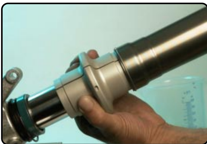
...in Außenrohr klopfen oder drücken.
