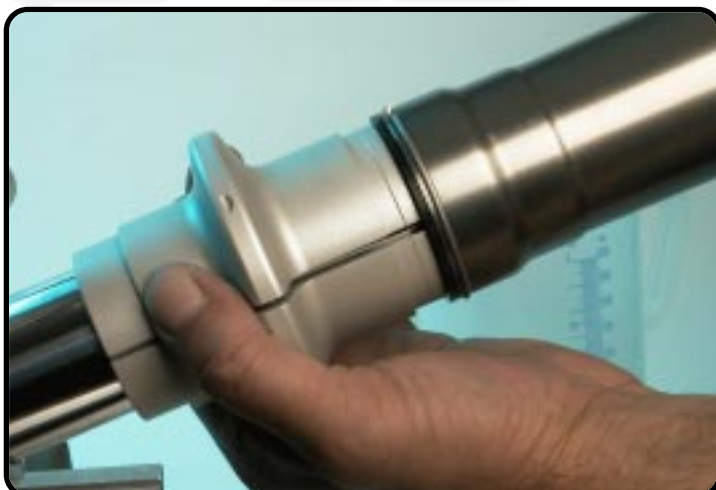
Staubmanschette mit T1402S montieren.
