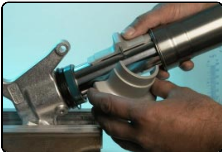
Außenrohr mit flacher Seite von T1402S montieren...
