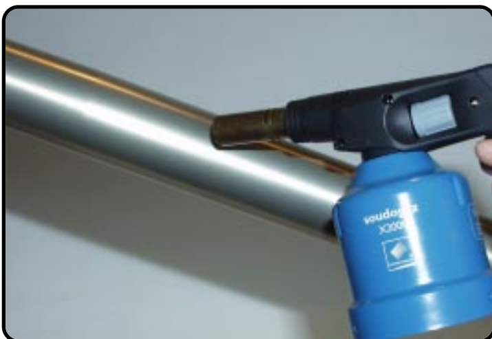
2. Außenrohr auf Höhe Führungsbüchse erwärmen.
