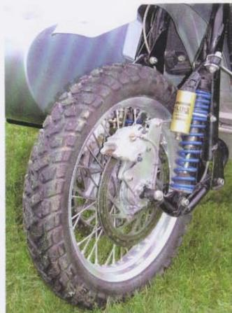
Edle Brembo-Stopper mit 300-Millimeter-Scheiben sorgen für eine der Motorleistung angemessene Verzögerung.
