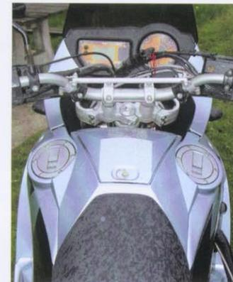
Im Cockpit rechts der Drehzahlmesser, links die multifunktionale Cockpitanzeige mit Tageskilometerzähler, Tankstopp-Distanzanzeige, Gesamtkilometer, Geschwindigkeitsanzeige, Zeit, Benzinwarmlampe, Kühlwassertemperatur, Kontrollleuchten und Tripmaster. Mittig am Tank das praktische Handschuhfach.
